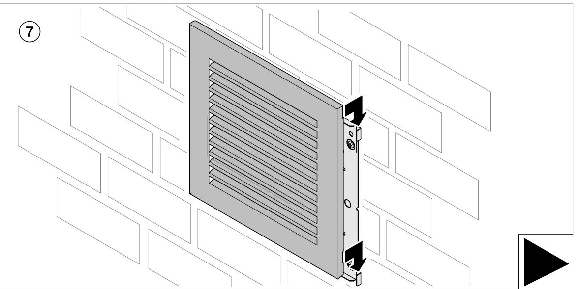
**D** Dieser Mauerkasten ist für die Kombination mit einer Miele Dunstabzugshaube geeignet. Die integrierte Rückstauklappe sorgt dafür, dass bei ausgeschalteter Dunstabzugshaube kein ungewollter Luftaustausch zwischen Raum- und Außenluft stattfindet. Nach dem Einschalten der Dunstabzugshaube wird die Rückstauklappe durch den Abluftdruck geöffnet, so dass die Abluft ungehindert nach außen transportiert werden kann.
