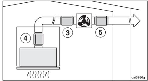
Um Gebläsegeräusche in der Küche zu minimieren, ist der Schalldämpfer möglichst vor dem externen Gebläse zu positionieren ③, bei einer langen Abluftleitung am Abluftstutzen der Dunstabzugshaube ④. Bei einem externen Gebläse, das im Haus montiert ist, ist durch Einsatz eines Schalldämpfers hinter dem externen Gebläse ⑤ eine Verringerung der Gebläsegeräusche nach außen möglich.
