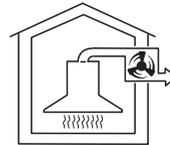
Bei Dunstabzugshauben, die für den Betrieb mit einem externen Gebläse vorbereitet sind, wird ein Miele Absauggebläse außerhalb des Raumes an einem Standort Ihrer Wahl montiert. Das externe Gebläse wird durch eine Steuerleitung mit der Dunstabzugshaube verbunden und über Con@ctivity oder über die Bedienelemente der Dunstabzugshaube gesteuert.
