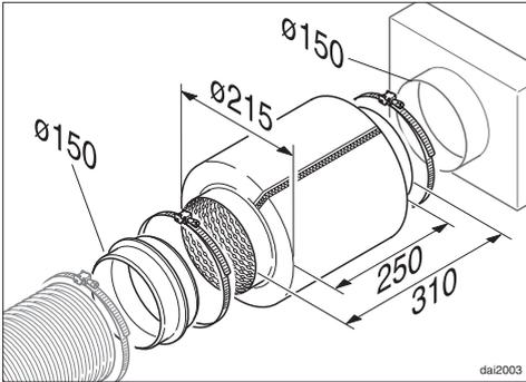
In die Abluftleitung kann ein Schalldämpfer eingesetzt werden (nachkaufbares Zubehör). Er dient zur zusätzlichen Geräuschkämpfung.
