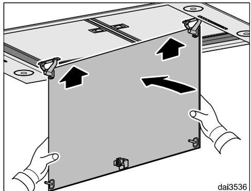
■ Halten Sie mit einer Hand das Paneel und lösen Sie mit der anderen Hand die Verriegelung. Schwenken Sie das Paneel nach unten.
