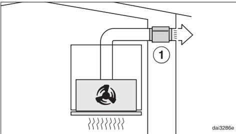
Der Schalldämpfer dämpft sowohl Gebläsegeräusche nach außen als auch Außengeräusche, die über die Abluftleitung in die Küche dringen (z. B. Straßenlärm). Dazu wird der Schalldämpfer möglichst nah vor dem Abluftaustritt ① positioniert.
