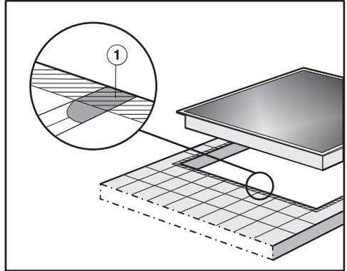
Die Fugen ① und der schraffierte Bereich unter der Auflagefläche des Kochfeldes müssen glatt und eben sein, damit das Kochfeld gleichmäßig aufliegt und die Dichtung unter dem Rand des Geräteoberteils die Abdichtung zur Arbeitsplatte gewährleistet.
